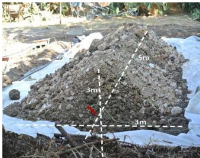
Рис.3.7 Земляной обнулитель изолированный непроводящей тканью
