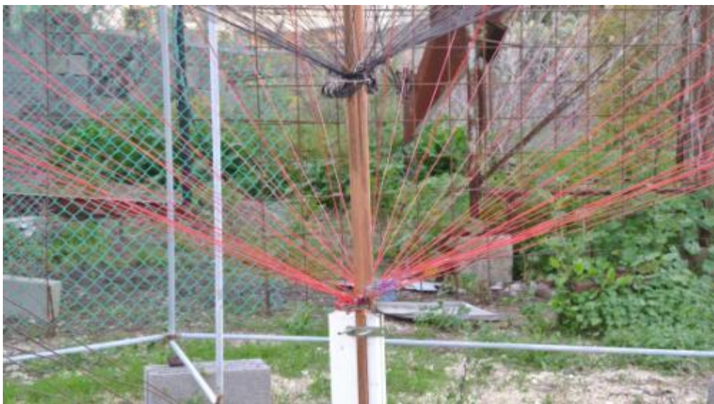
Рис. 3.14 Фотография экспериментального воздушного обнулителя
