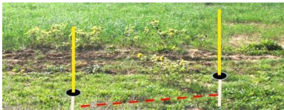
Рис 3.1 Измерение сопротивления земли
