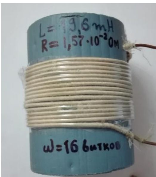
Фото 7. Катушка №3: диаметр каркаса 74 мм, провод – медь, \varnothing 2,0 мм, 16 витков.
