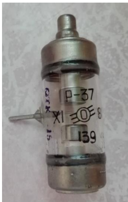
Фото 3. Разрядник газонаполненный P-37 с тремя электродами
