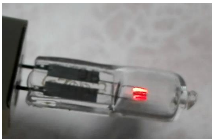
Фото 30. На третьем разряде нить накаливания становится ещё более нагретой, а белая вспышка становится ещё меньше.
