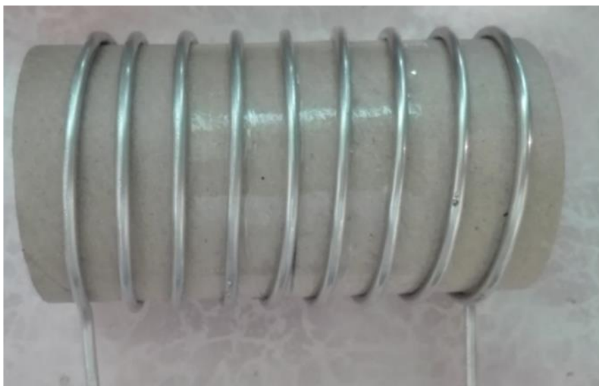
Фото 5. Вторичная катушка №1: диаметр каркаса 64 мм, провод – алюминий, \varnothing 3,2 мм, 9 витков.
