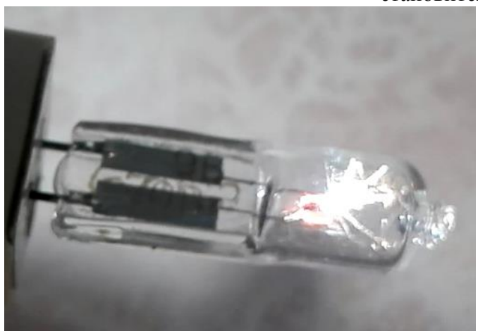
Фото 31. На четвёртом разряде нить накаливания ещё более нагретая, а белая вспышка ещё меньше.
