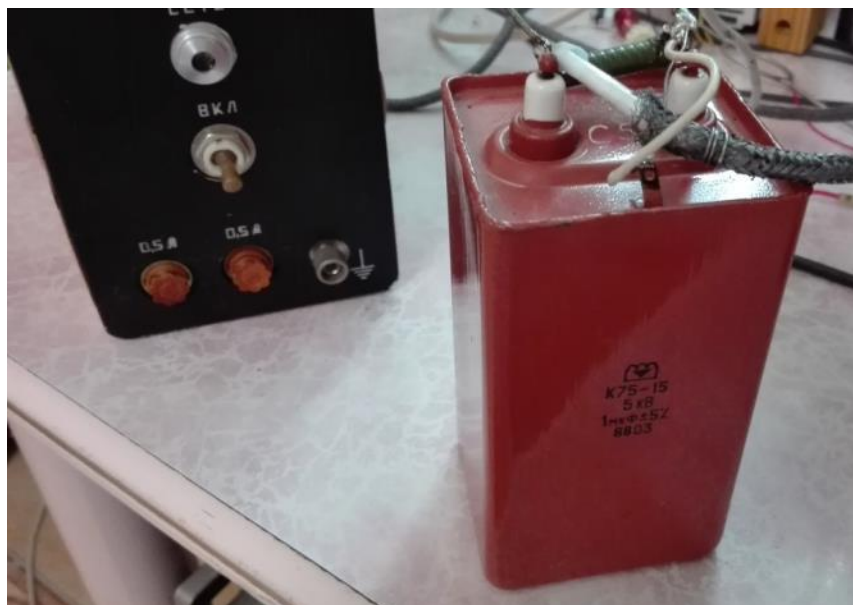
Фото 2. Масляный высоковольтный конденсатор 1\mu\text{F} \times 5 кВ
