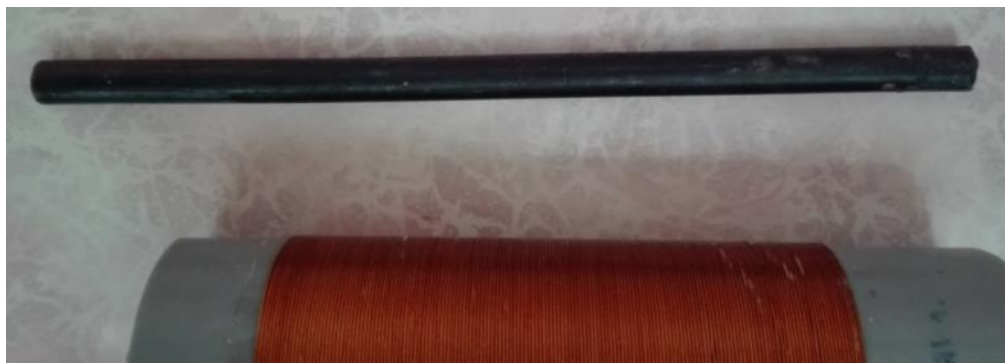
Фото 9. Ферритовые сердечники 50ВЧ и М400НН и диаметром 10 мм и длиной 200 мм.
