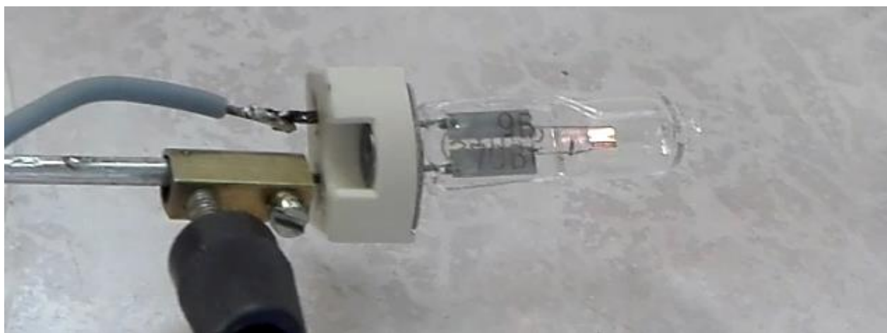
Фото 22 - здесь лампа подключена к 9-му витку.
