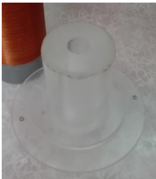
Фото 10. Стойка под катушки и ферриты.
