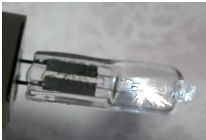
Фото 30. На третьем разряде нить накаливания становится ещё более нагретой, а белая вспышка становится ещё меньше.
