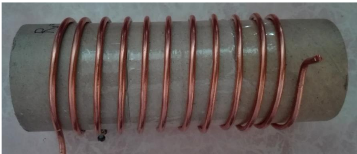
Фото 6. Вторичная катушка №2: диаметр каркаса 64 мм, провод – медь, \varnothing 3,5 мм, 11 витков.
