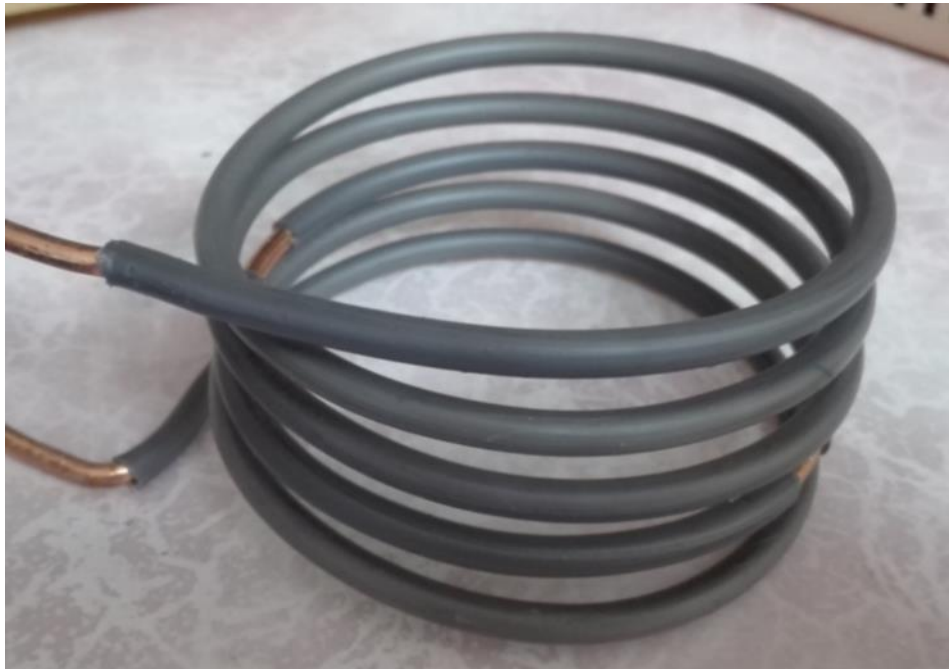
Фото 8. Катушка №3: вну. диаметр каркаса 82 мм, провод – медь, \varnothing 3,5 мм, 5 витков.
