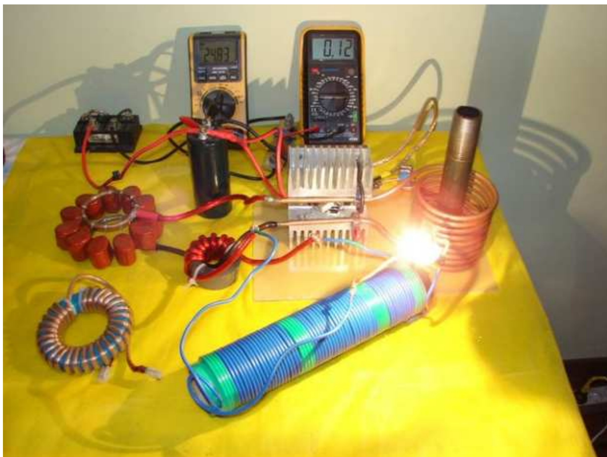
Нагрев трубы без трансформатора тока:
