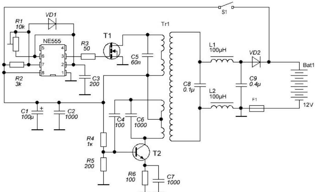
Схема состоит из двух генераторов. На микросхеме NE 555 и транзисторе Т1 выполнен генератор низкой частоты (НЧ генератор), формирующий короткие импульсы с частотой следования 50-100 Кгц. На транзисторе Т2 собран высокочастотный генератор (ВЧ генератор).
