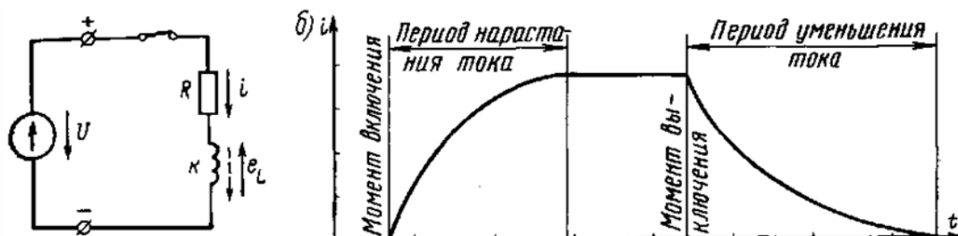
Рис. 62. Электрическая цепь с катушкой индуктивности (а) и кривая изменения в ней тока при включении и выключении (б)
