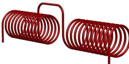
Ну а теперь начнем с начала. Мотаем вот такую катушку. Строго симметрично относительно центра катушки. Прошу обратить внимание, что одна половина катушки намотана навстречу другой половине, т.е. имеем одну из разновидностей бифилярной катушки.
