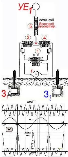
Эти соленоиды, каждый соединены со своим заземлением 3<sub>1</sub> и 3<sub>2</sub>. Возбуждённая энергия каждого из соленоидов, импульсно поступает в своё заземление.
