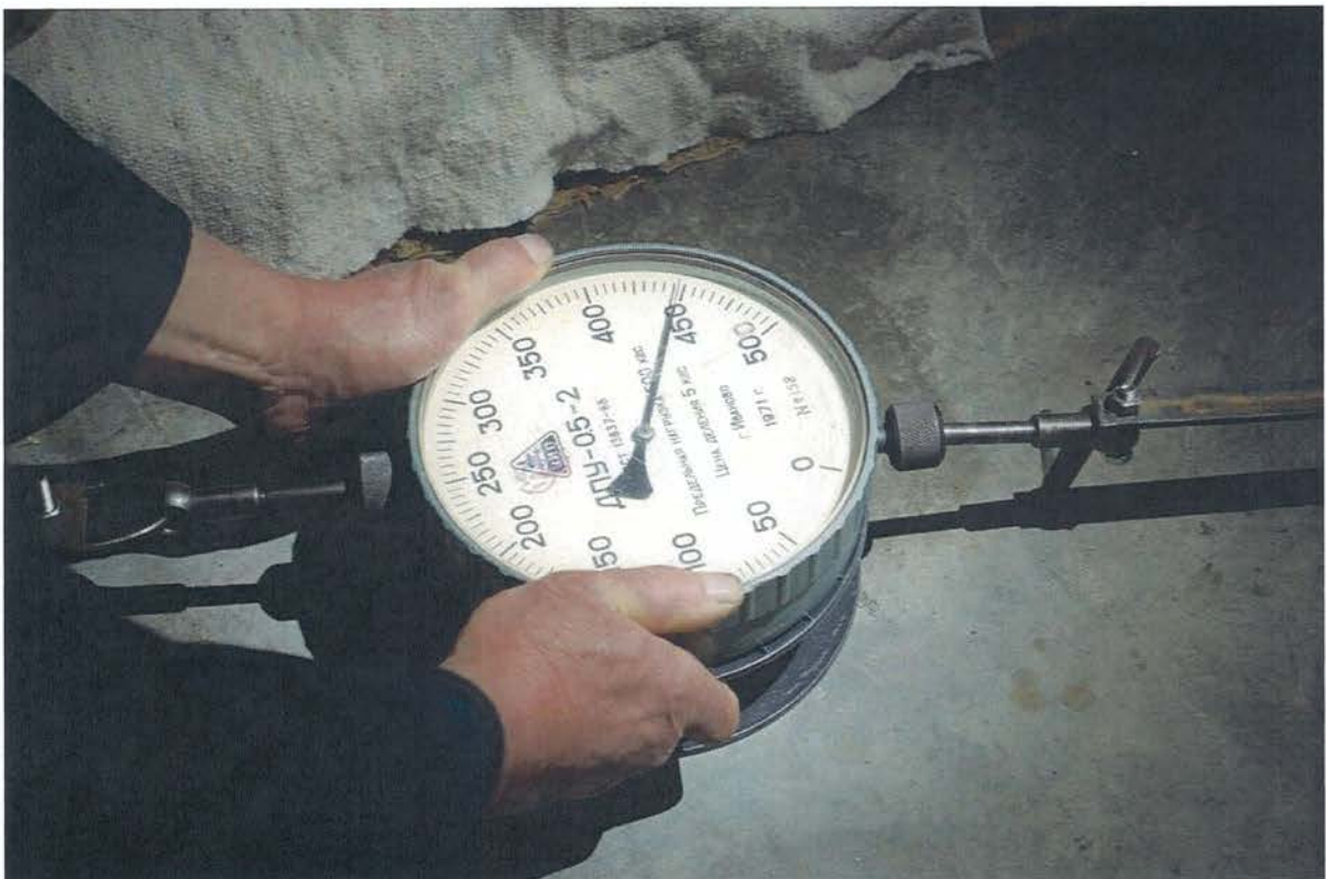
Фото 7. Отклонение стрелки динамометра на 450 кгс при прохождении импульса силы, генерируемого КвД-1-2009. Динамометр приходится придерживать руками от вибрации, создаваемый мощным импульсом силы.
