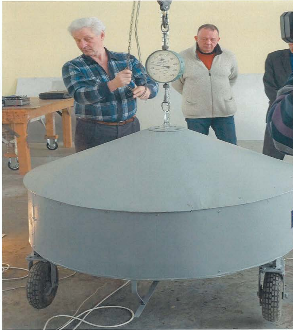
Фото 4. Взвешивание аппарата с КвД-1-2009 (видно отсутствие привода и тормозов на колеса)
