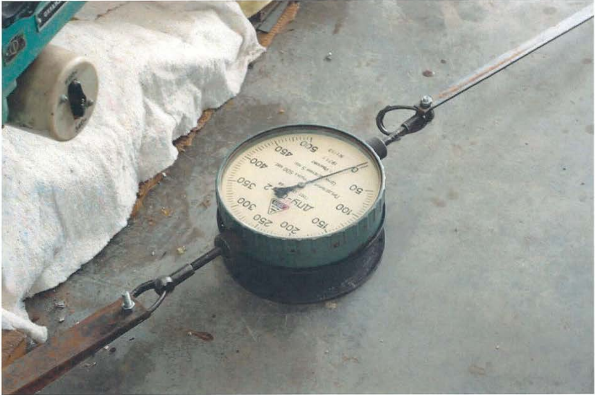
Фото 6. Нулевое положение стрелки динамометра ПДУ при отсутствии силы.
